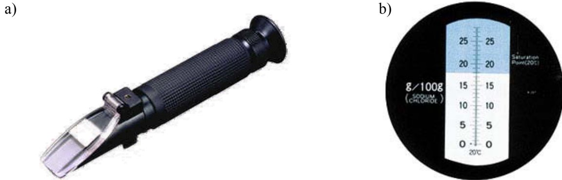
Figura 11: Medición de conductividad del fluido intersticial. a) Refractómetro de salinidad b) mira y escala de salinidad.
